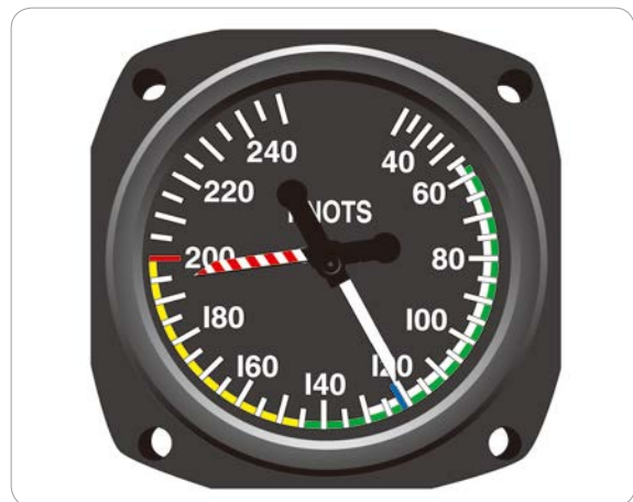
[그림 3-12] 최대 허용 속도 지시계는 Never-exceed Speed를 지시하는 바늘과, 천음속 충격파 발생을 피하기 위해 고도에 따라 변함
