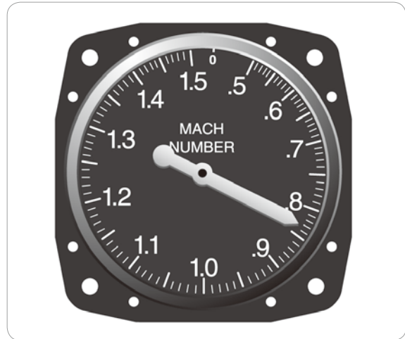
[그림 3-11] 마하수는 음속 대 항공기가 비행하는 진대기 속도의 비율
