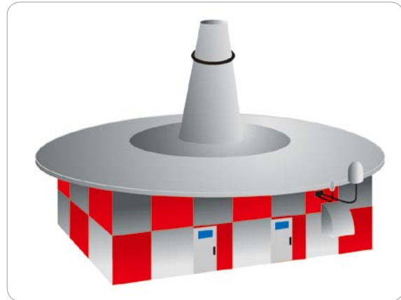
[그림 2-11] VOR transmitter (ground station)
