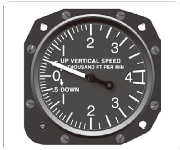
[그림 3-14] VSI 분당 1000 피트 단위로 상승, 강하를 표시
