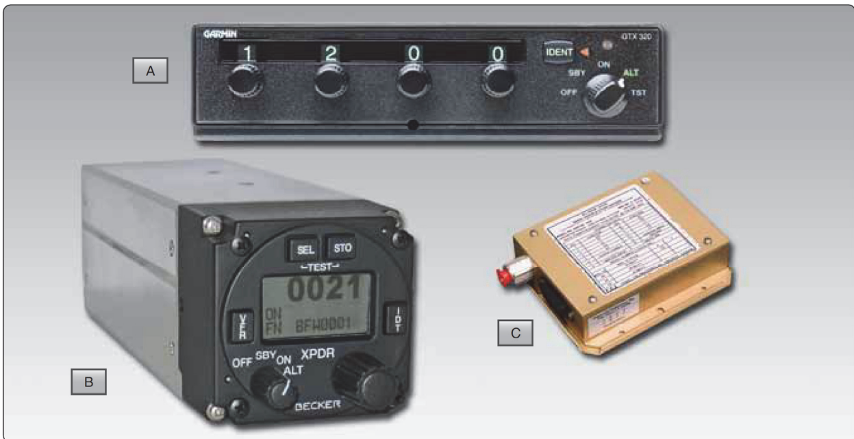
[그림 4-142] 트랜스폰더와 고도부호기(altitude encoder)
