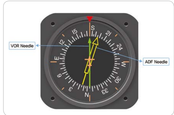
[그림 3-6] RMI(Radio Magnetic Indicator)
