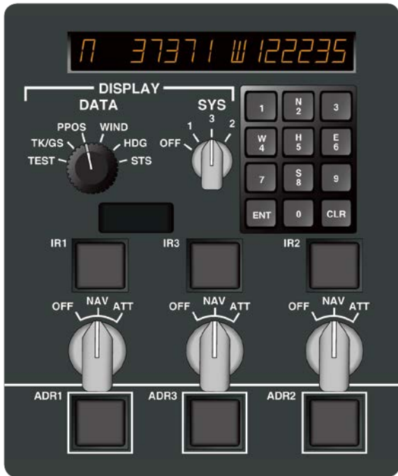
[그림 3-68] IRS(Inertial Reference Systems)
