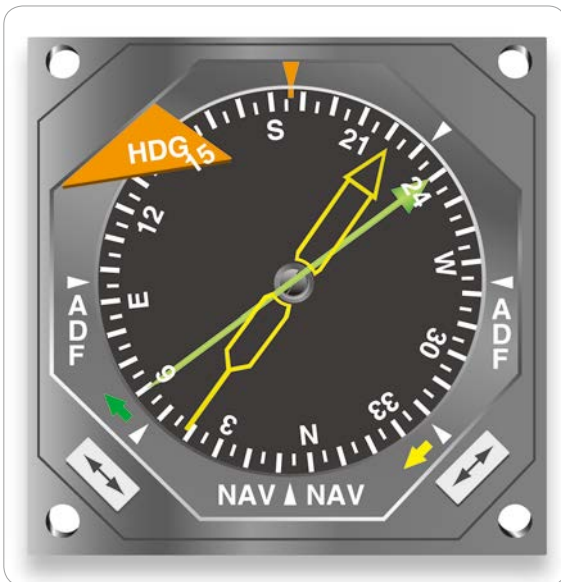
[그림 3-42] RMI(Radio Magnetic Indicator)
