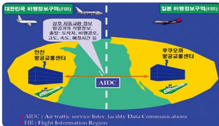
[그림 1-34] 항공관제 정보교환 시스템(AIDC) 운용 개념도
