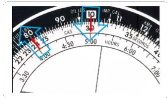
[그림 3-123] 계산반을 이용한 나누기 계산
