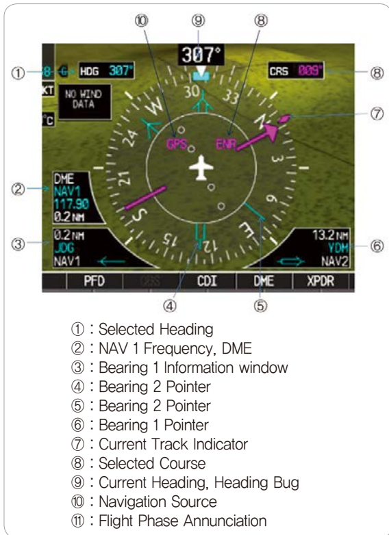
[그림 3-53] Electronic Flight Instruments의 HSI
