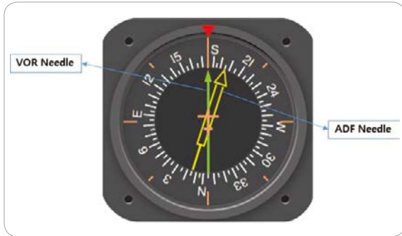
[그림 3-44] RMI를 이용한 항공기 위치 파악
