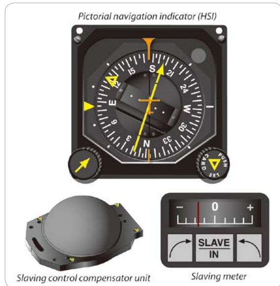
[그림 3-17] Directional gyro Slaving system
