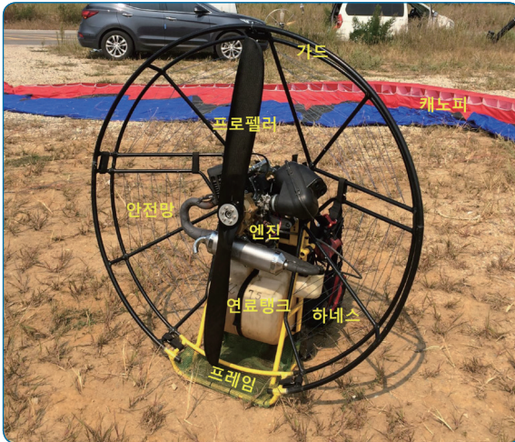
[그림 4-50] PPG 구조 및 명칭
