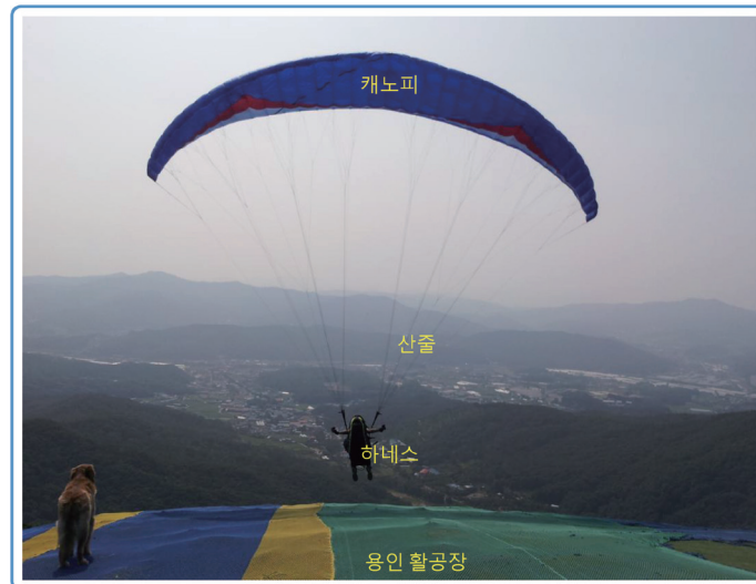
[그림 5-5] 패러글라이더의 구조 및 명칭
