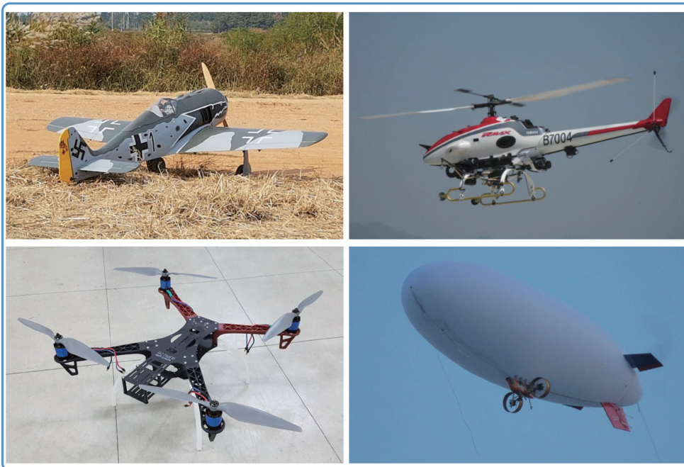
[그림 6-1] 무인비행장치 좌상) 무인비행기, 우상) 무인헬리콥터, 좌하) 무인멀티콥터, 우하) 무인비행선
