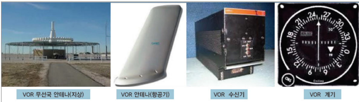
[그림 5-5] 초단파전방향표지장치 주요 구성품 (VOR system components)
