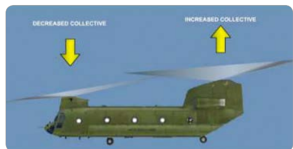
[그림 3-66] Tandem Rotor 헬리콥터의 자세 조종
