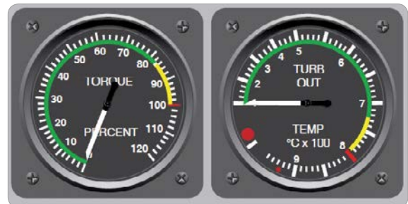
[그림 2-105] Torque and Turbine Outlet Temperature(TOT) Gauges
