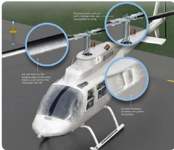
[그림 2-78] 헬리콥터 기체 Icing 사례
