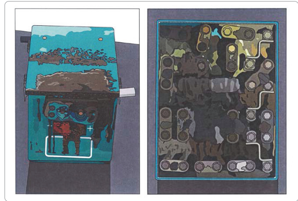
[그림 9-10] 배터리 열폭주 현상
