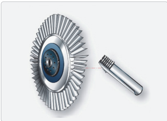
[그림 3-60] 터빈깃의 fir-tree 설계 및 lock-tab고정방식
